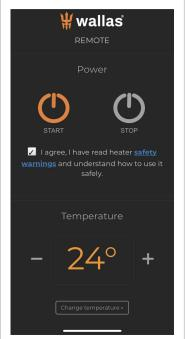
Wenn Sie die App öffnen und keine lokale Verbindung hergestellt werden kann, können Sie auf das Heizgerät zugreifen, indem Sie REMOTE LINK wählen. Bitte beachten! Bevor Sie das Heizgerät verwenden, müssen Sie die Sicherheitshinweisen lesen und akzeptieren (durch Anklicken ein Häkchen in das Kästchen "I agree..." setzen).
